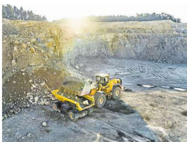
Der selbstfahrende elektrische Dumper wird im Steinbruch Gabenchopf in Villigen mit Kies beladen. Bild: Daniel Hager/zvg
